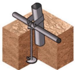
Anclaje en tierra con tornillo o perno
